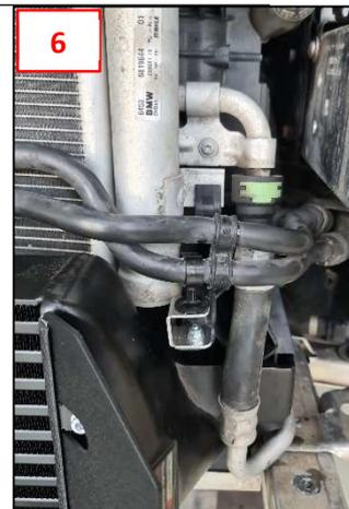
Befestigen Sie die Ladeluftschläuche am WT-Ladeluftkühler und sichern Sie diese mit den serienmäßigen Spangen. Bringen Sie die abmontierten Bauteile in umgekehrter Reihenfolge an. Die große Plastikverkleidung in der Front entfällt oder kann entsprechend ausgeschnitten werden. Montieren Sie die Stoßstange. Ziehen Sie alle Schrauben fest und prüfen Sie alles auf korrekten Sitz.
